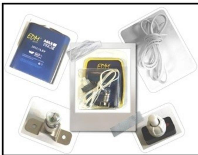
Para el montaje de un circuito eléctrico haciendo uso de los elementos anteriores, basta con poner en contacto la batería a través de los polos positivo (el de mayor longitud) y negativo (el más corto), la bombilla y el interruptor mediante conexiones a través del cable de cobre, pelando previamente los extremos aislantes del cable para liberar los penachos de cobre (material conductor).
